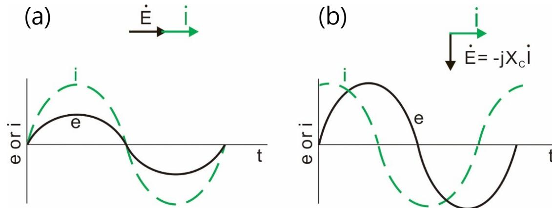
圖3. 電位與電流通過電阻(a)與電容(b)之示意圖
